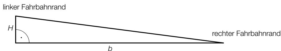
Der Höhenunterschied  $H$  zwischen dem linken und dem rechten Fahrbahnrand wird üblicherweise in Zentimetern angegeben, die horizontale Breite  $b$  jedoch in Metern.
