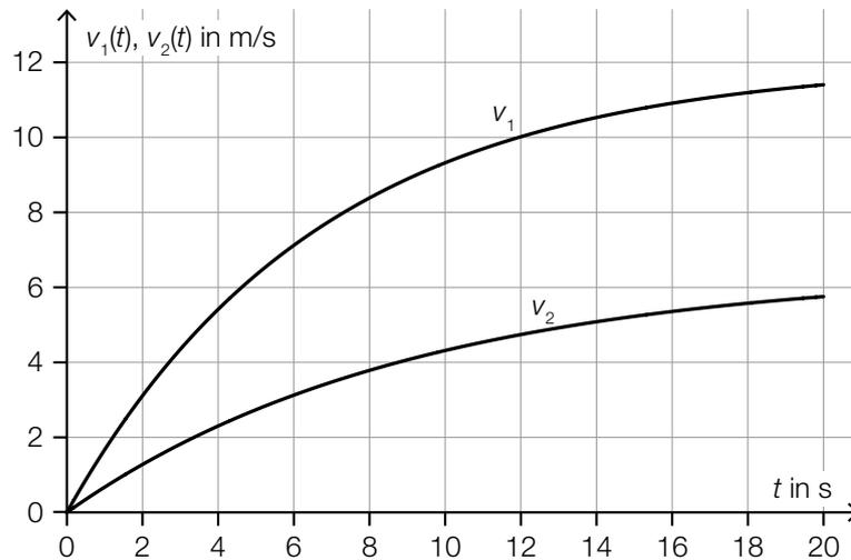
Aufgrund der unterschiedlichen Geschwindigkeiten der beiden E-Bikes in den ersten 20 s werden Strecken unterschiedlicher Länge zurückgelegt. Die Differenz der Längen dieser beiden Strecken soll ermittelt werden.
