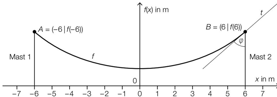
Der Mast 2 schließt mit der Tangente  $t$  an den Graphen von  $f$  im Aufhängungspunkt  $B$  den Winkel  $\varphi$  ein.
