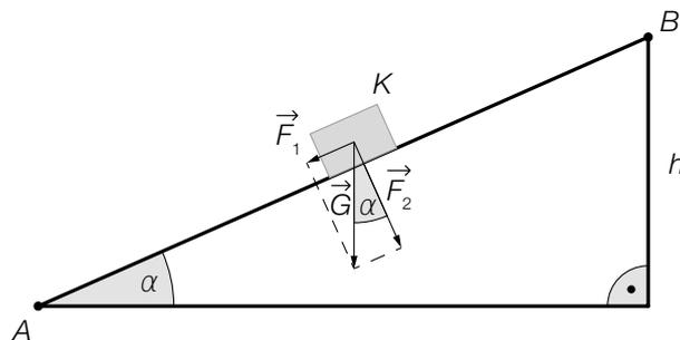
Die Längen  $G$ ,  $F_1$  und  $F_2$  der Vektoren entsprechen den Größen der Kräfte (in N).
