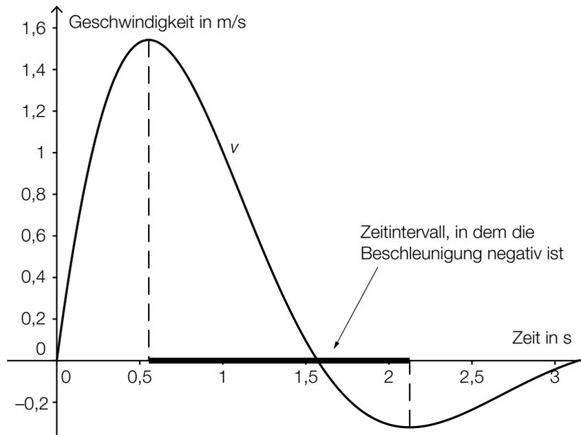
Da der Flächeninhalt oberhalb der Zeitachse (= Weglänge in Vorwärtsrichtung) deutlich größer ist als jener unterhalb der Zeitachse (= Weglänge in Rückwärtsrichtung), befindet sich das Werkstück am Ende der Bewegung nicht wieder in der Ausgangsposition.
