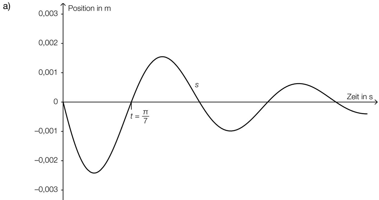
Nach  $\frac{\pi}{7}$  Sekunden befindet sich das Bauteil erstmals wieder in der Ausgangslage.
